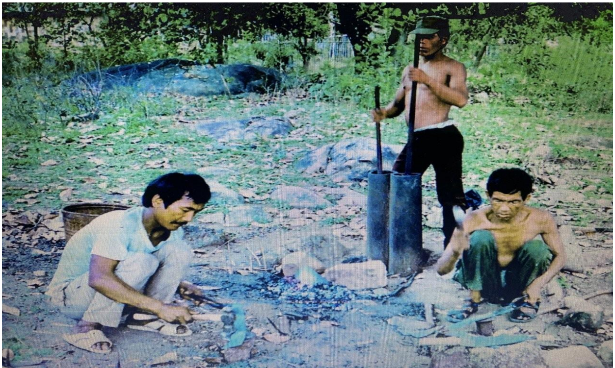
Các công cụ sản xuất được rèn thủ công
